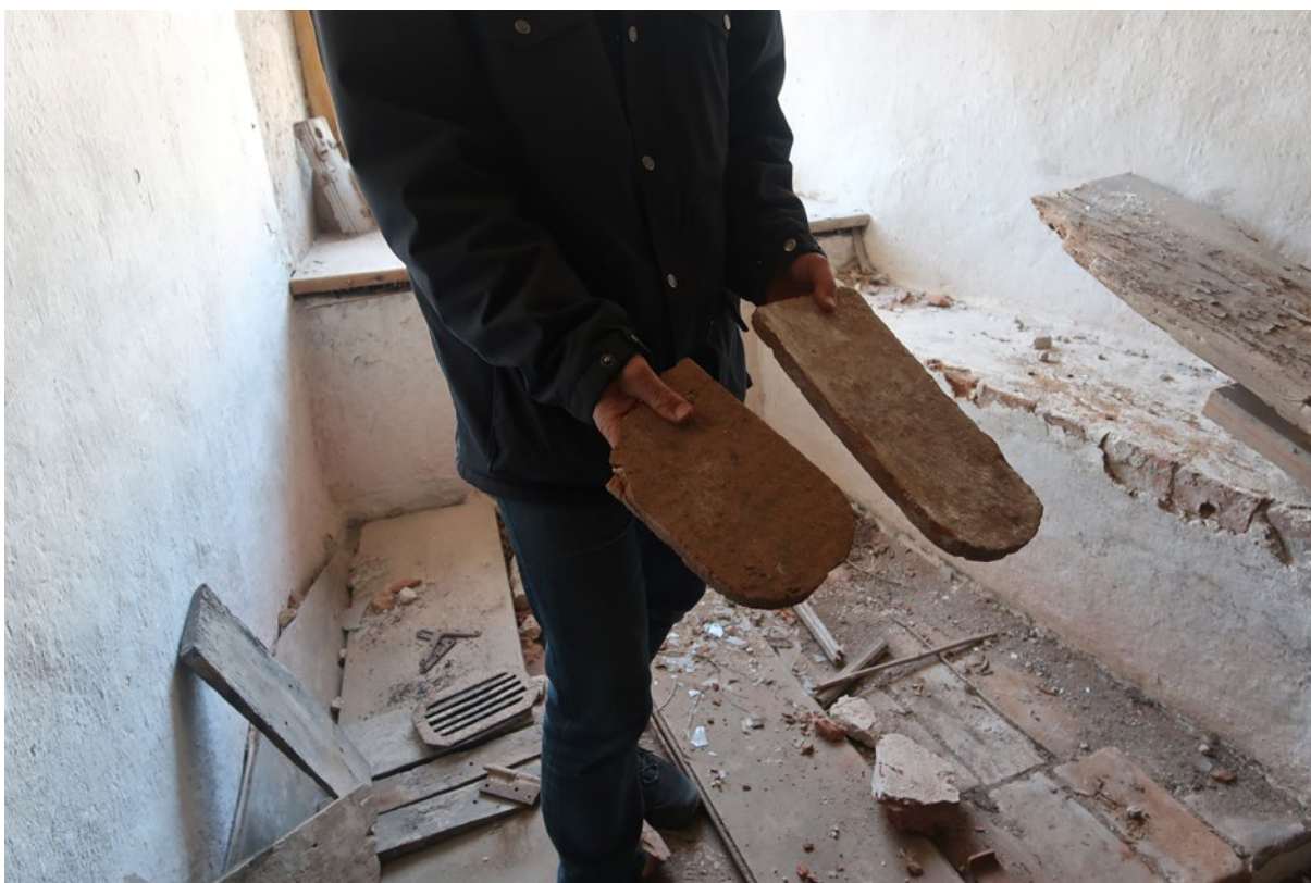
Rum 109. I fönsternischen finns en samling tillvarataget byggmaterial. Örjan Molander visar här medeltida fjälltegel. Typen är mycket ovanlig och tyder på att Vinäs slott varit en högreståndsmiljö. Det enda övriga fynd av fjälltegel som är känt i Kalmar län kommer från Kalmar slott.
