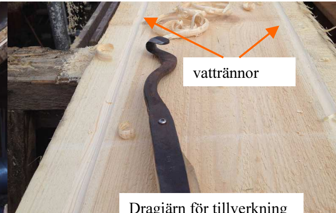
Dragjärn för tillverkning av vattrännor
