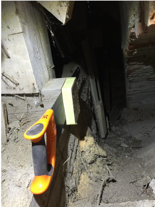
Sågskivor togs från tre olika takstolar. Bilden visar provtagning från en redan tidigare avsågad stickbjälke.
