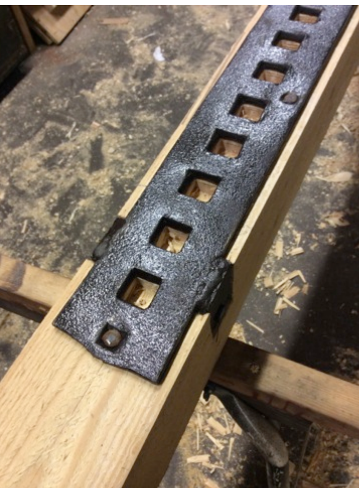
Spettjärnet är handsmitt med drivna hål, inte borrade, som håller flera spettluckors livslängd.
