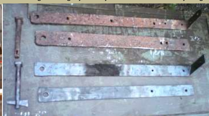
Äldre förlaga av hängseljärn där järnet är en återbrukad hjulring.
